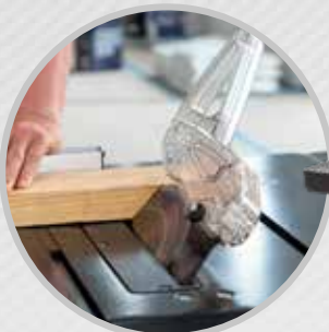
EIXO INCLINÁVEL DE ATÉ 45°
