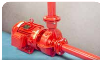
Alinhamento perfeito entre a motobomba e tubulação
